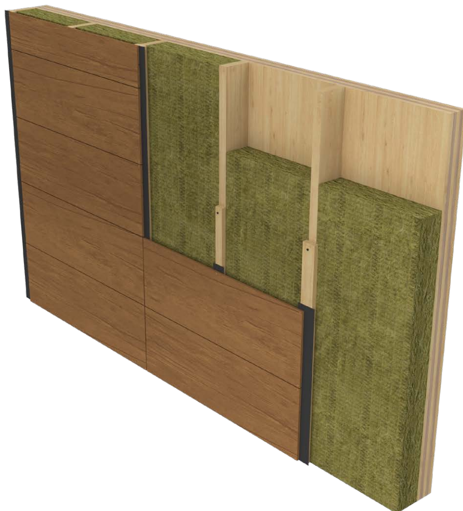
UNDERKONSTRUKTION AV TRÄ
