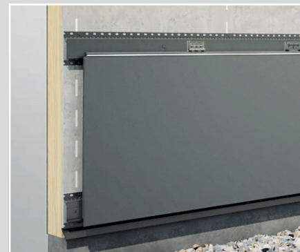
EX Futura, 16 x 455 x 1818 mm med MolaVent, ventilerad vågrät underkonstruktion. Monteras på cc 455 mm
