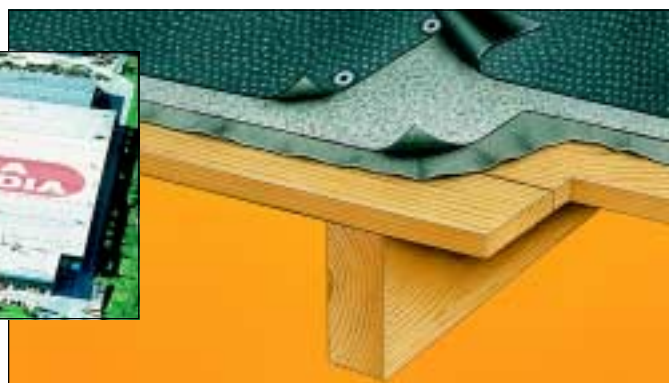
1. Protan SE 2. Isolering 3. Fuktspärr 4. Bärande underlag
